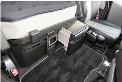
De I-Shift versnellingshendel zit in de weg wanneer de la geopend wordt
