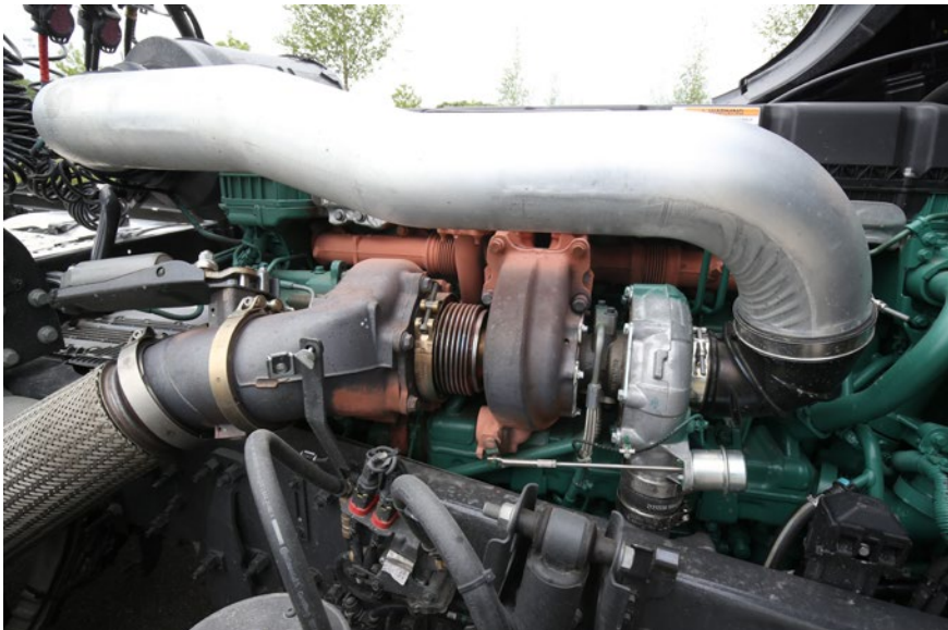
De Turbo Compound gebruikt restwarmte uit de uitlaatgassen en zorgt voor extra koppel
