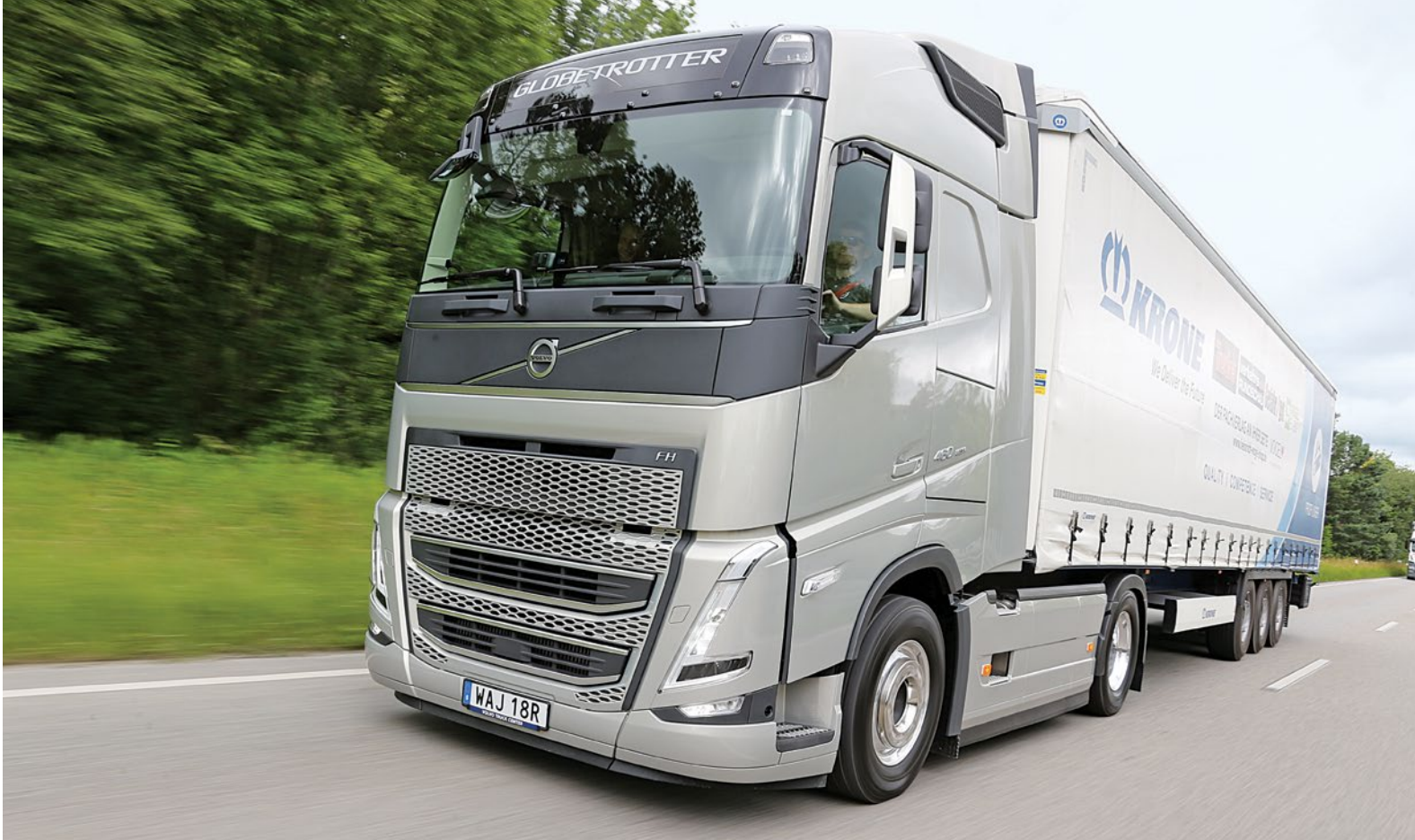
Slanke koplampen en op de deur gemonteerde richtingaanwijzers zijn onderscheidende kenmerken van de nieuwe FH
